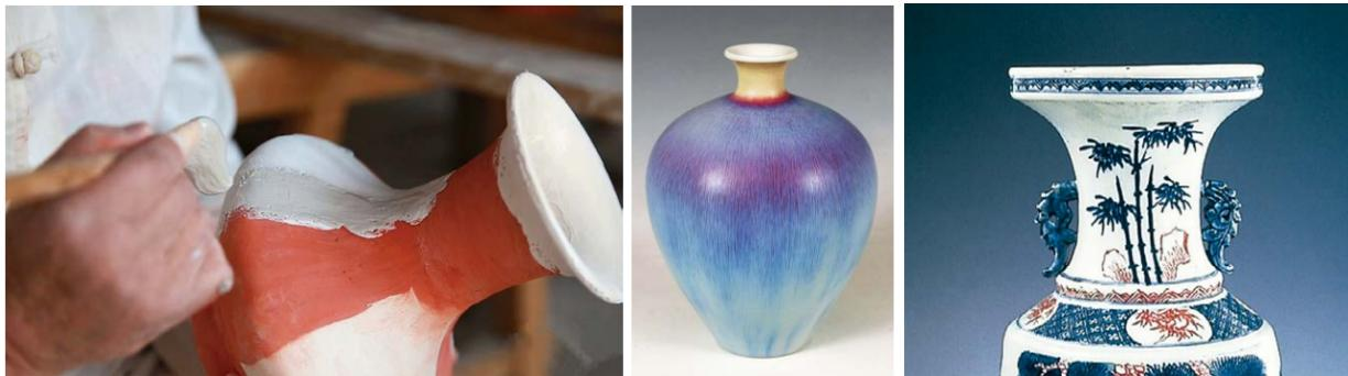
瓷器制作时，在基础釉料中分别加入铁、铜、钴等氧化金属着色剂，经过一定的烧成温度和火焰气氛，烧成后，瓷器釉面分别形成青、红、蓝等不同的色泽，这种瓷器，我们称之为颜色釉瓷。
