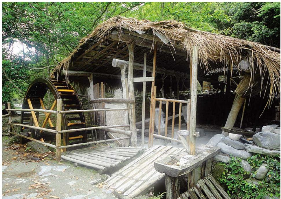
水碓是以木料为原料，利用水势作动力碾制瓷土，设计巧妙，制作精良，使用方便的瓷业技艺。浮梁使用水碓的历史悠久，伴随着景德镇陶瓷生产的全过程。史书称“新平冶陶，始于汉世”。新平即浮梁的古称。在浮梁境内，现存为数众多的五代、宋、元以降的古瓷石矿坑、古窑址。这说明，古时浮梁农户就已经开始采挖瓷石，利用水碓碾制瓷土，或自制瓷器，
